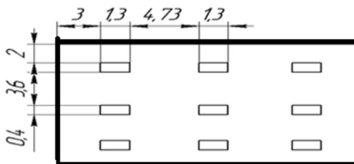
Рисунок 1 (или Рисунок 1.1) – План расположения светильников
