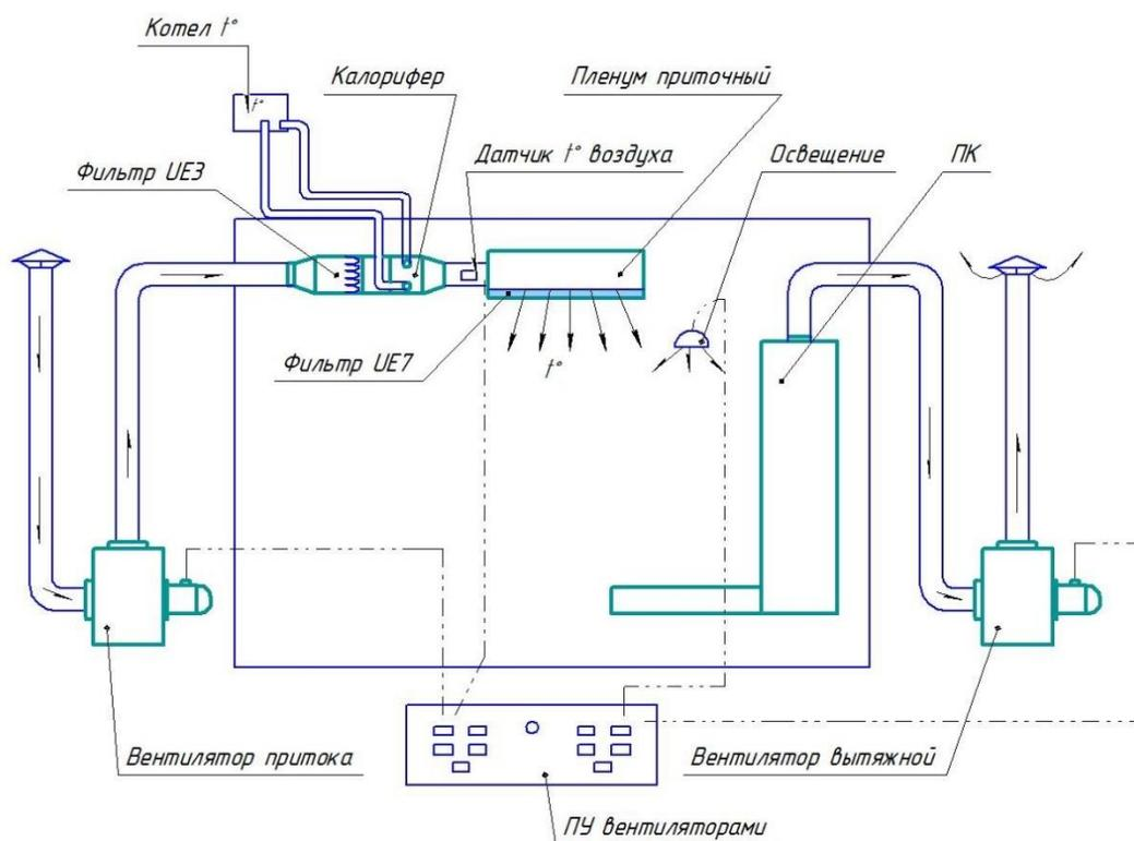
Рис. 3.2 - Классическая схема расположения покрасочной камеры
